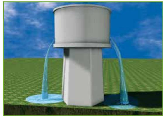
저수탑과 같이 운영 중에 저수조 내부에서 방수 (Positive side 방수)가 불가능하다. 이와 같은 경우 저수조 외부에서 실시하는 방수 (Negative side 방수)가 필요하다.
